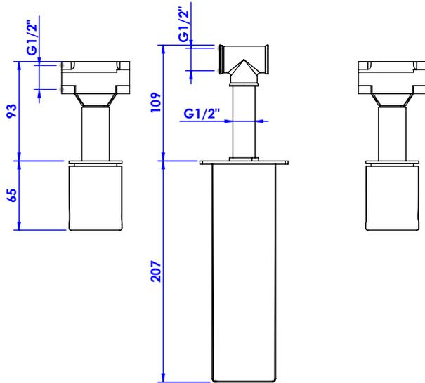
**Débit / Flow rate : 22.8 - 25.3 l/min (sous 3 bars).**
