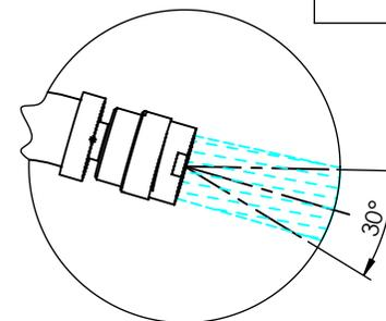
**Débit / Flow rate : 21 l/min (sous 3 bars).**
