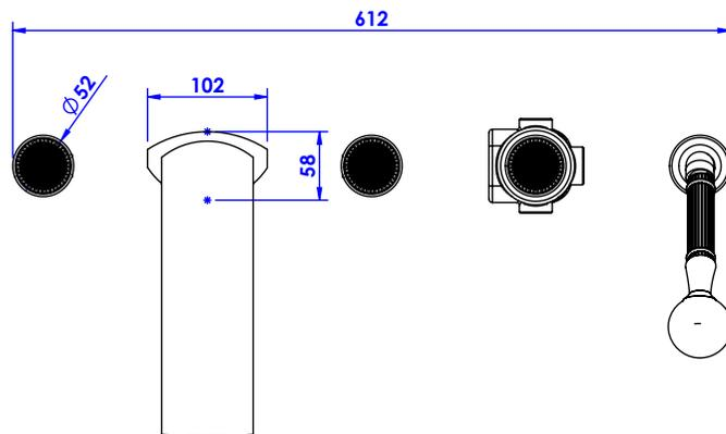
$\varnothing$  de perçage et entraxe recommandés.
