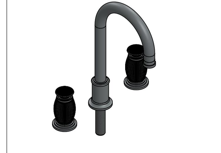
Débit / Flow rate : 15 l/min (sous 3 bars).
