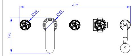
ø de perçage et entraxe recommandés. ø recommended drilling and centre distances.
