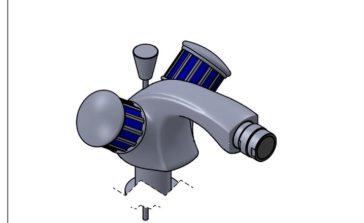
**Débit / Flow rate : 21 l/min (sous 3 bars).**
