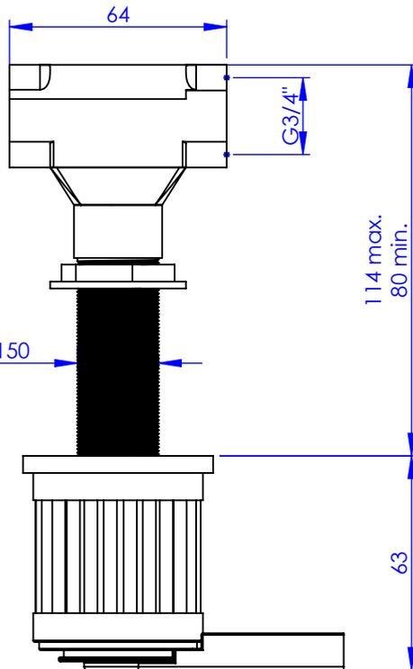
**Débit / Flow rate : 36 l/min (sous 3 bars).**
