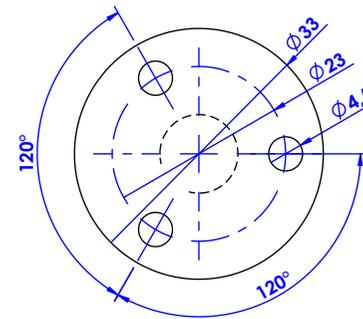
$\phi$  de perçage recommandé.
