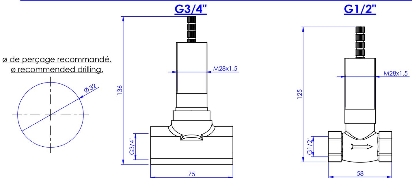
Débit / Flow rate : 36 l/min (sous 3 bars)
