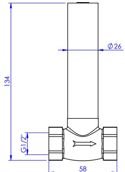
Débit / Flow rate : 21 l/min (sous 3 bars)
