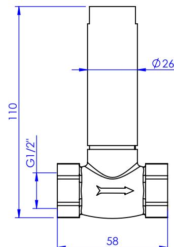
Débit / Flow rate : 36 l/min (sous 3 bars)
