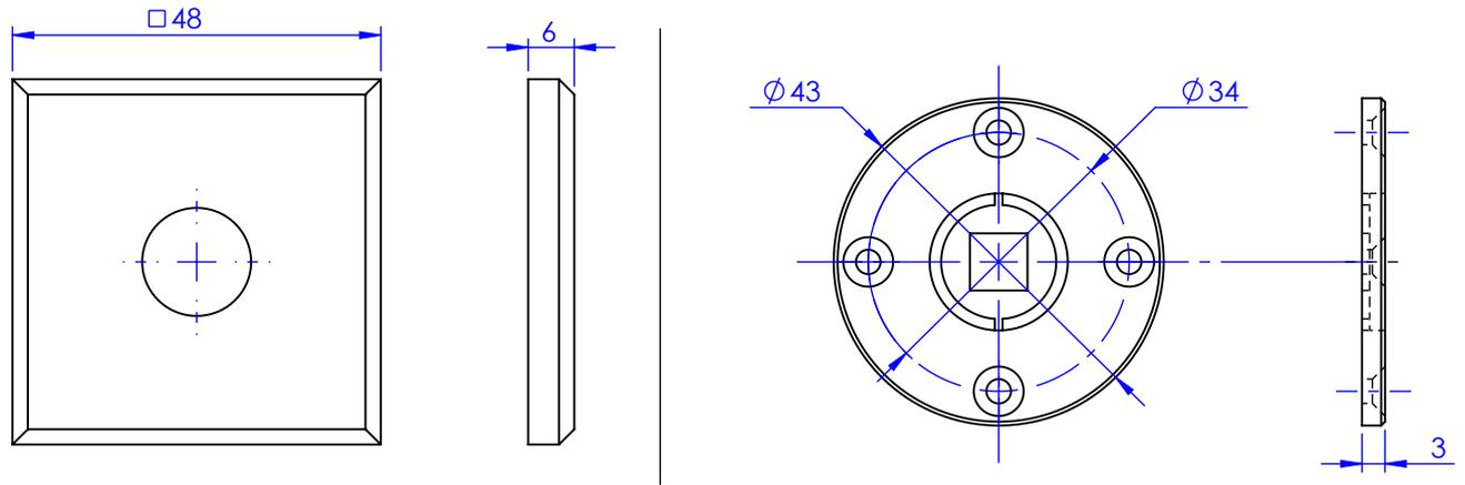
Rosaces de fonction avec leurs embases de fixation. / *Function rosettes, with fixing plate.*
