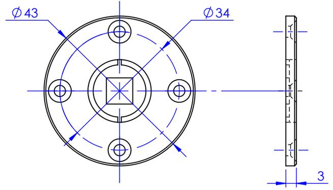
Rosaces de fonction avec leurs embases de fixation. / *Function rosettes, with fixing plate.*
